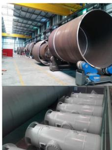
A A. Silva Matos Metalomecânica S.A produziu diversos reservatórios de ar comprimido a alta pressão e uma conduta forçada para diversas obras de aproveitamento hidroelétrico internacionais.
