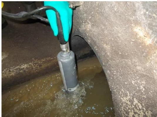
Figura 4.8 – Medição pontual de condutividade na rede de drenagem
