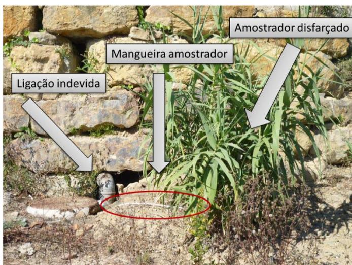
Figura 4.6 - Colocação de amostrador disfarçado para amostragem de ligação indevida
