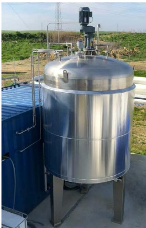
Figura 7. Imagem de um bioreactor de  $8 \text{ m}^3$  no exterior de um contentor marítimo.
