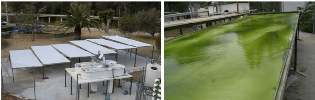
Figura 11 - Fotobiorreator thin-layer da Universidade de Cádiz instalado na ETAR de Arcos de la Frontera (Cádiz, Espanha)
