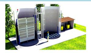
A ONIS GROUP, S.A. adjudicou ao grupo Moinhos Água e Ambiente, a conceção e execução de uma ETAR para instalação no Hospital Militar de Luanda. A ETAR recorre a tecnologia MBR (Membrane Bio Reactor), com membranas submersas planas e terá uma
